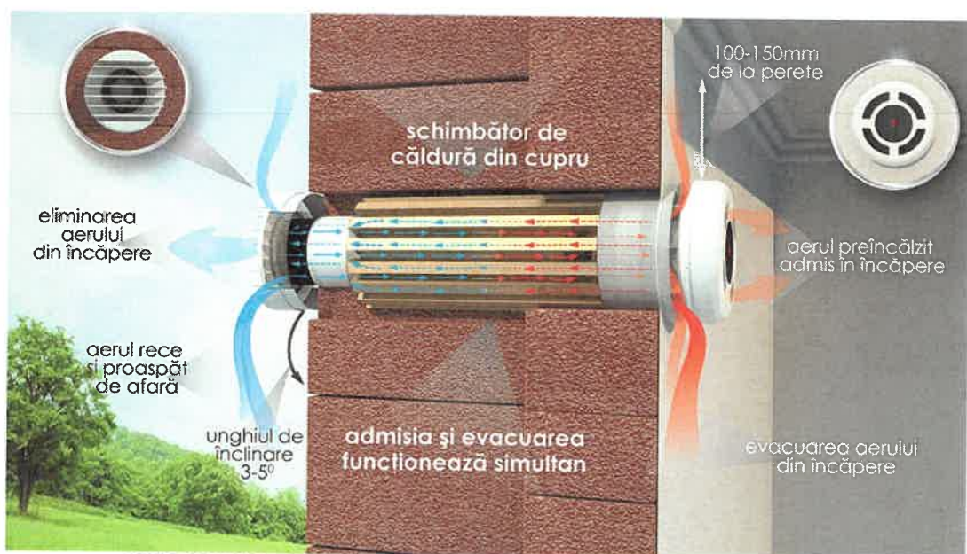
PRINCIPIUL DE FUNCȚIONARE AL RECUPERATORULUI
